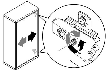
Öffnungsmechanismus der oberen Glastür einstellen | Régler le mécanisme d'ouverture de la porte en verre supérieure
